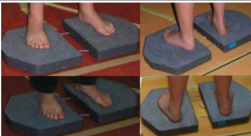
Ryc. 2. Indywidualne ustawienie kończyn na dwuplatofrmowej wadze stabilograficznej
