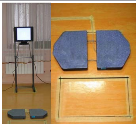
Ryc. 3. Rozmieszczenie aparatury pomiarowej do badań „Stanie swobodne” z oczami otwartymi (fit back wzrokowy)
