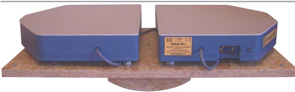
Ryc. 6. Dwuplatformowa waga tensometryczna na platformie balansowej
