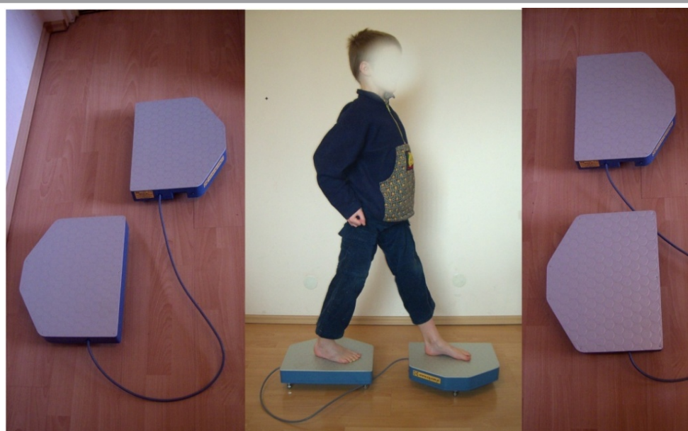
Ryc. 3. Możliwość rozstawienia płyt wagi stabilograficznej
