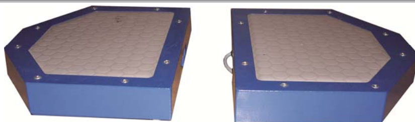
Ryc. 2 Dwuplatformowa waga stabilograficzna
